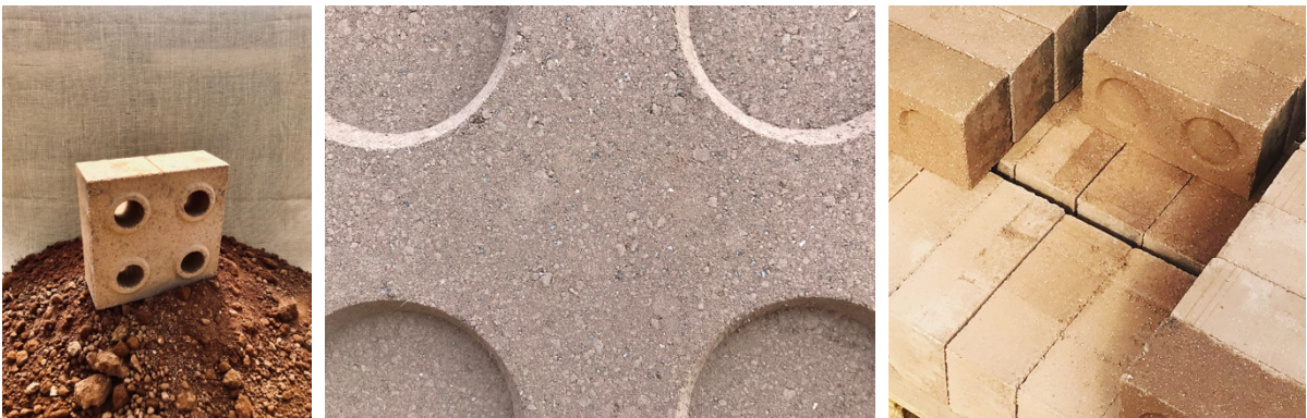
Imagen 06: Bloques de Tierra Comprimida
