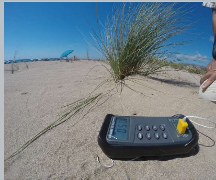
29-08-2015 Gavà. Un termopar enterrat a 3mm de profunditat mostra una temperatura de 50°C
